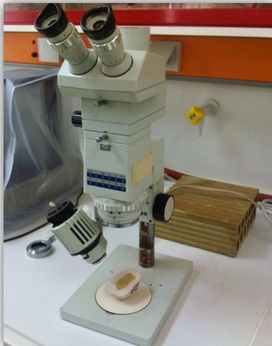
Εικόνα 5.2. Μελέτη δοκιμίου ελέγχου της συμβατότητας στο στερεοσκόπιο.
