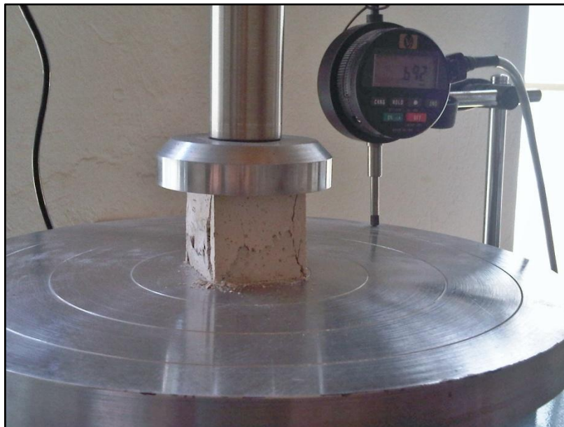
Εικόνα 4.6. Αστοχία δοκίμιου κονιάματος κατά τη δοκιμή της αντοχής του σε μονοαξονική θλίψη.
