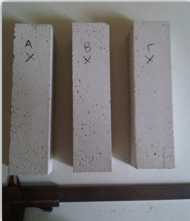
Εικόνα 3.7. Δοκίμια κονιάματος Κ.Χ.
