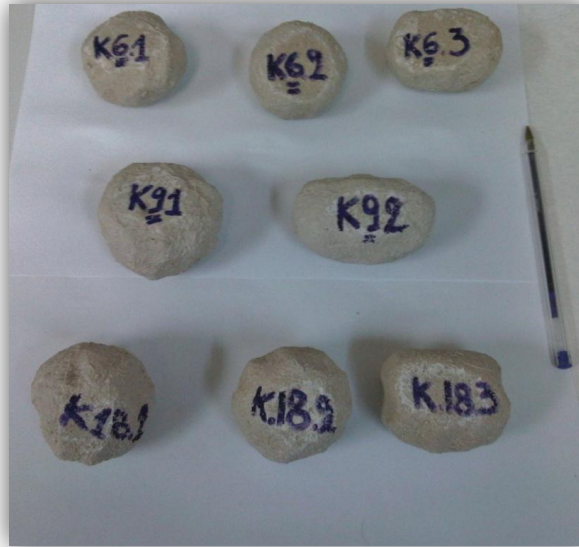
Εικόνα 5.1. Δοκίμια ελέγχου της συμβατότητας από το επιλεγμένο κονίαμα και τους διαφορετικούς δομικούς λίθους.
