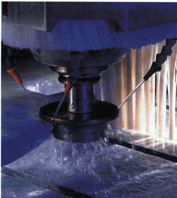
Σχ. 2.6ι. Λείανση πλάκας με περιστρεφόμενο τροχό.
