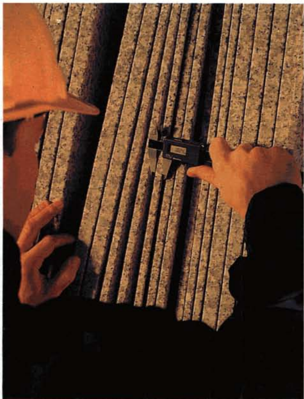
Σχ. 2.6ιβ. Έλεγχος του πάχους γρανιτικών πλακών μετά την κοπή του γρανιτικού όγκου.
