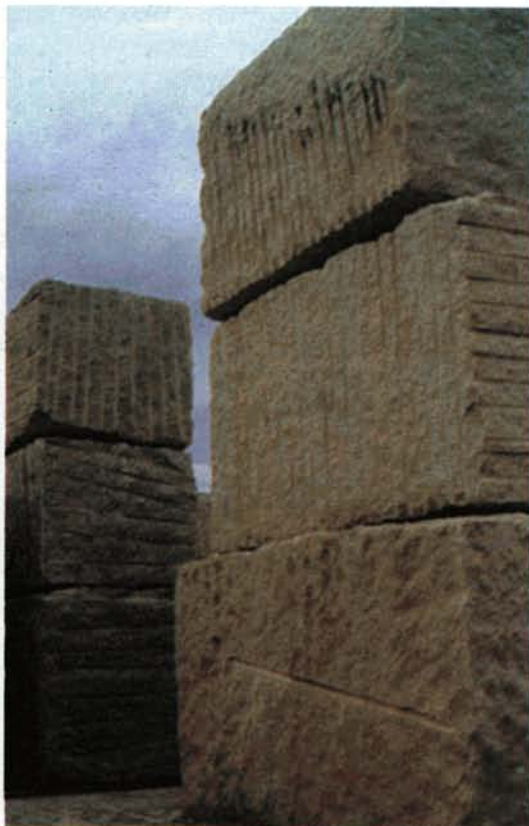
Σχ. 2.3β. Μεγάλοι ογκόλιθοι από γρανίτη που έχουν επεξεργασθεί κοντά στο σημείο εξορύξεώς τους.
