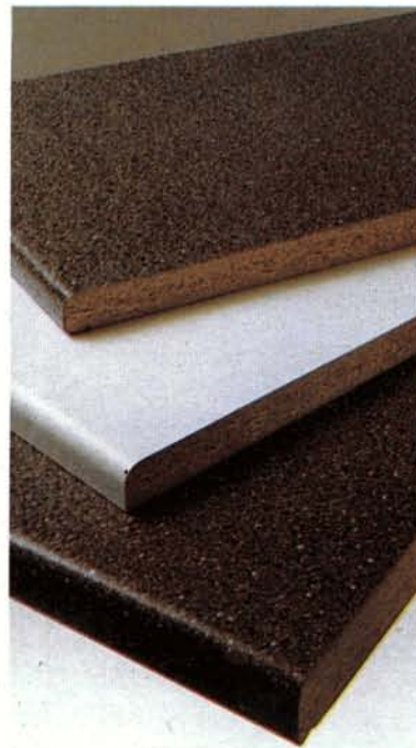
Σχ. 7.11ι. Μοριόπλακες με επένδυση λεπτής στρώσεως συνθετικών ρητινών.
