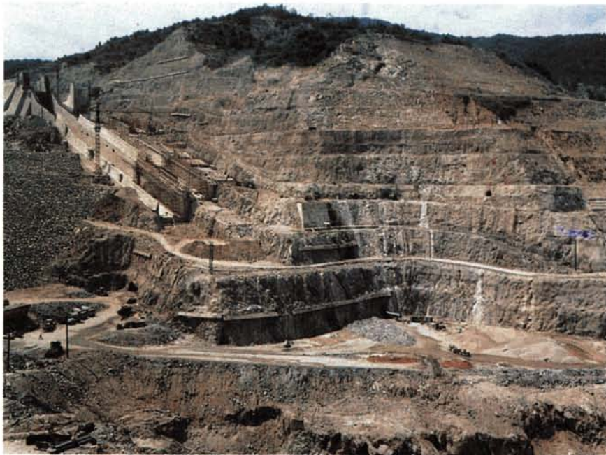
Σχ. 2.5γ. Φωτογραφία λατομείου εξορύξεως φυσικών λίθων κατά βαθμίδες και εγκατάσταση παραγωγής αδρανών υλικών.
