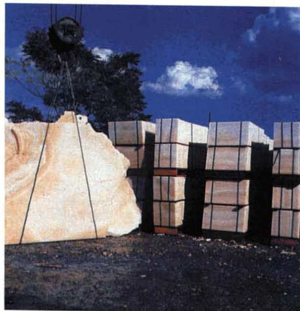
Σχ. 2.6ια. Αριστερά μεγάλη μαρμάρινη πλάκα που μεταφέρεται στο εργοστάσιο για κοπή και λείανση. Δεξιά συσκευασμένες πλάκες μαρμάρου προοριζόμενες για πώληση.
