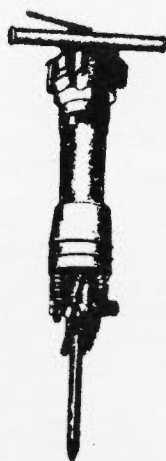
Εικ.150 Κρουστικό χειροκίνητο μηχάνημα (αερόσφυρα).
