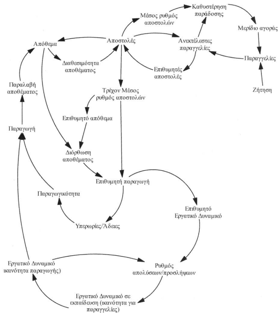
Σχήμα 8.4. Παράδειγμα δομής ενός συστήματος παραγωγής
