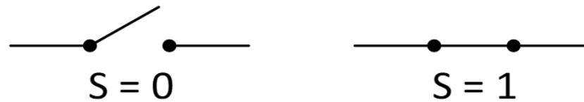
Σχήμα 3.1 Οι δύο καταστάσεις του διακόπτη
