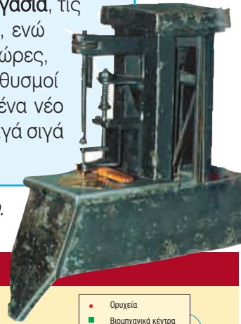
Η πρώτη ραπτομηχανή, εφεύρεση του Γάλλου Μπαρτολομέ Τιμονιέ το 1830.
