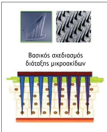
Εικόνα 22. Βασικός σχεδιασμός διάταξης μικροακίδων.
