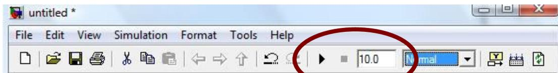
Το Simulink παρέχει την δυνατότητα παραγωγής σήματος συνεχούς και διακριτού χρόνου, καθώς και παραγωγή σήματος με χρήση δειγμάτων. Στην πρώτη περίπτωση, στο παράθυρο παραμετροποίησης της γεννήτριας επιλέγουμε “time-based” και εισάγοντας μηδενική τιμή στο “sample time” πεδίο, παίρνουμε χρονικά συνεχές σήμα. Αν εισάγουμε μη μηδενική τιμή, τότε έχουμε σήμα διακριτού χρόνου.
