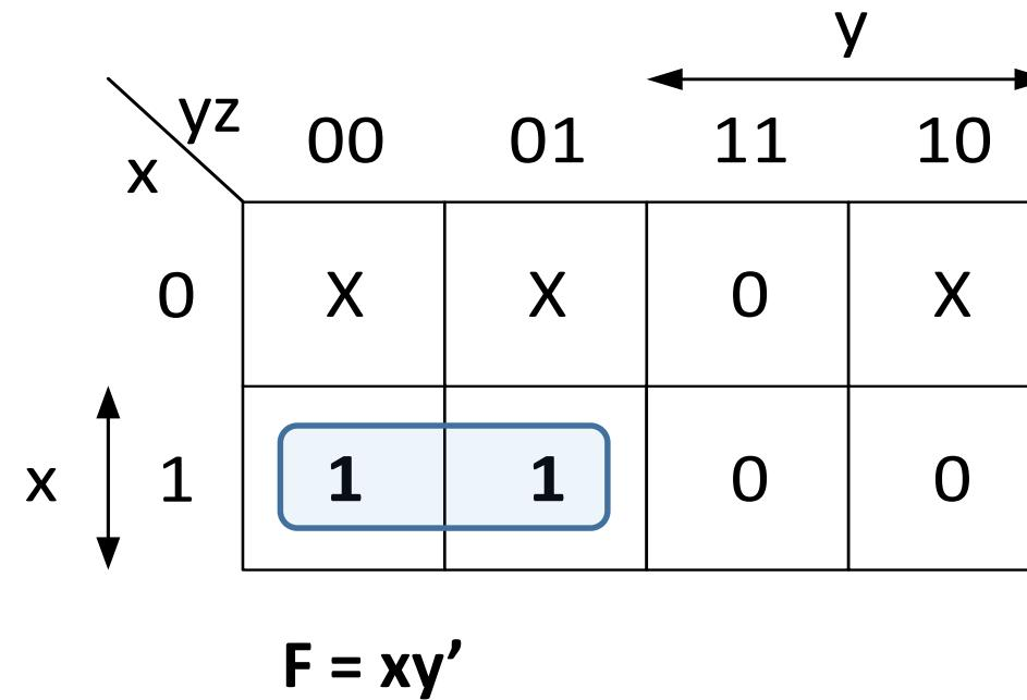
**Παράδειγμα 11:** Να ελαχιστοποιηθεί η συνάρτηση:  $F = \Sigma(4, 5) + d(0, 1, 2)$ .
