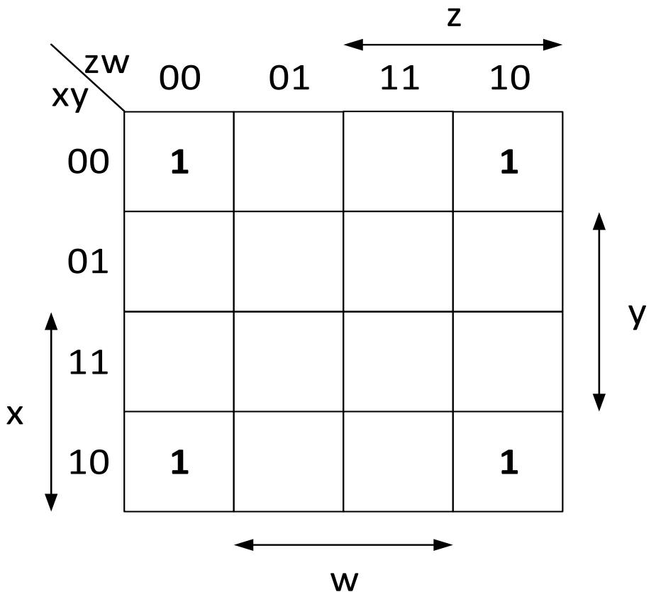
**Παράδειγμα 4.8:** Να ελαχιστοποιηθεί η συνάρτηση  $F(x, y, z, w) = \Sigma(0, 2, 8, 10)$ .
