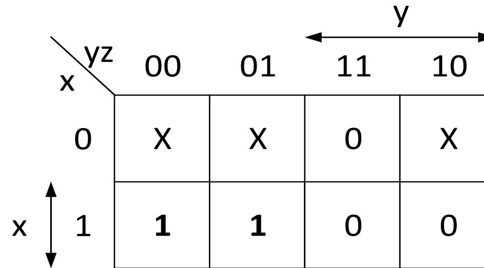
**Παράδειγμα 11:** Να ελαχιστοποιηθεί η συνάρτηση:  $F = \Sigma(4, 5) + d(0, 1, 2)$ .
