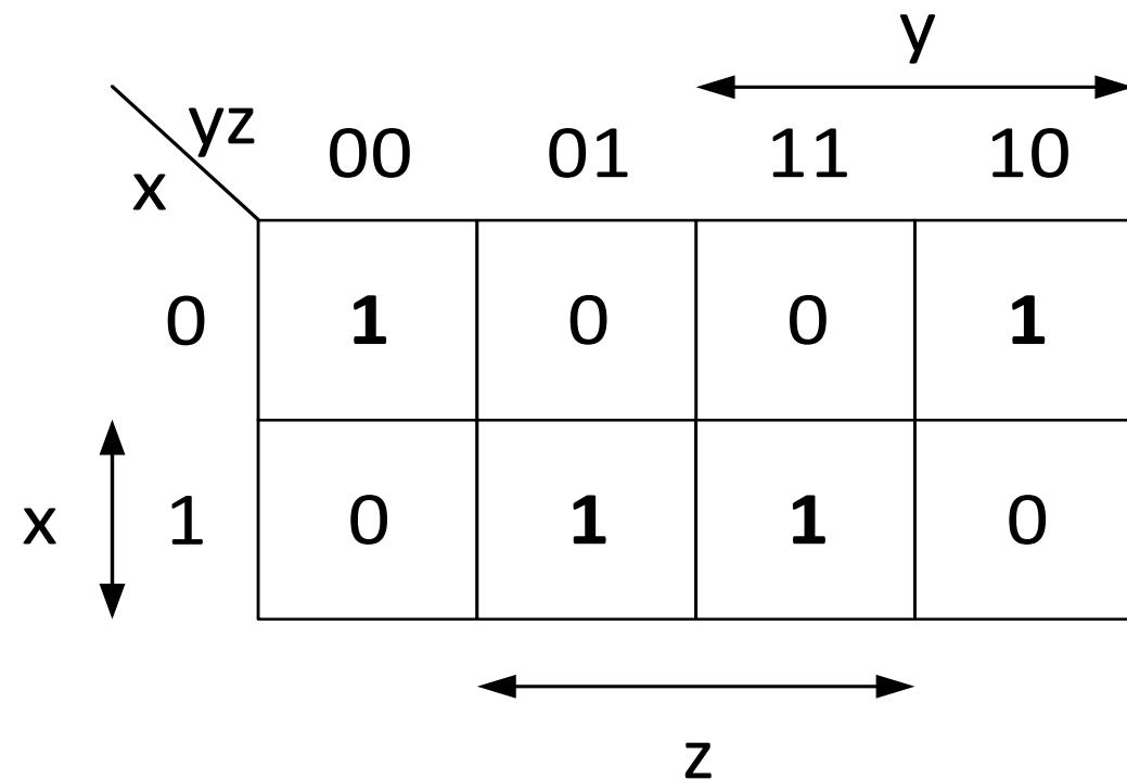
**Παράδειγμα 4.3:** Να ελαχιστοποιηθεί η συνάρτηση  $F(x, y, z) = \Sigma(0, 2, 5, 7)$
