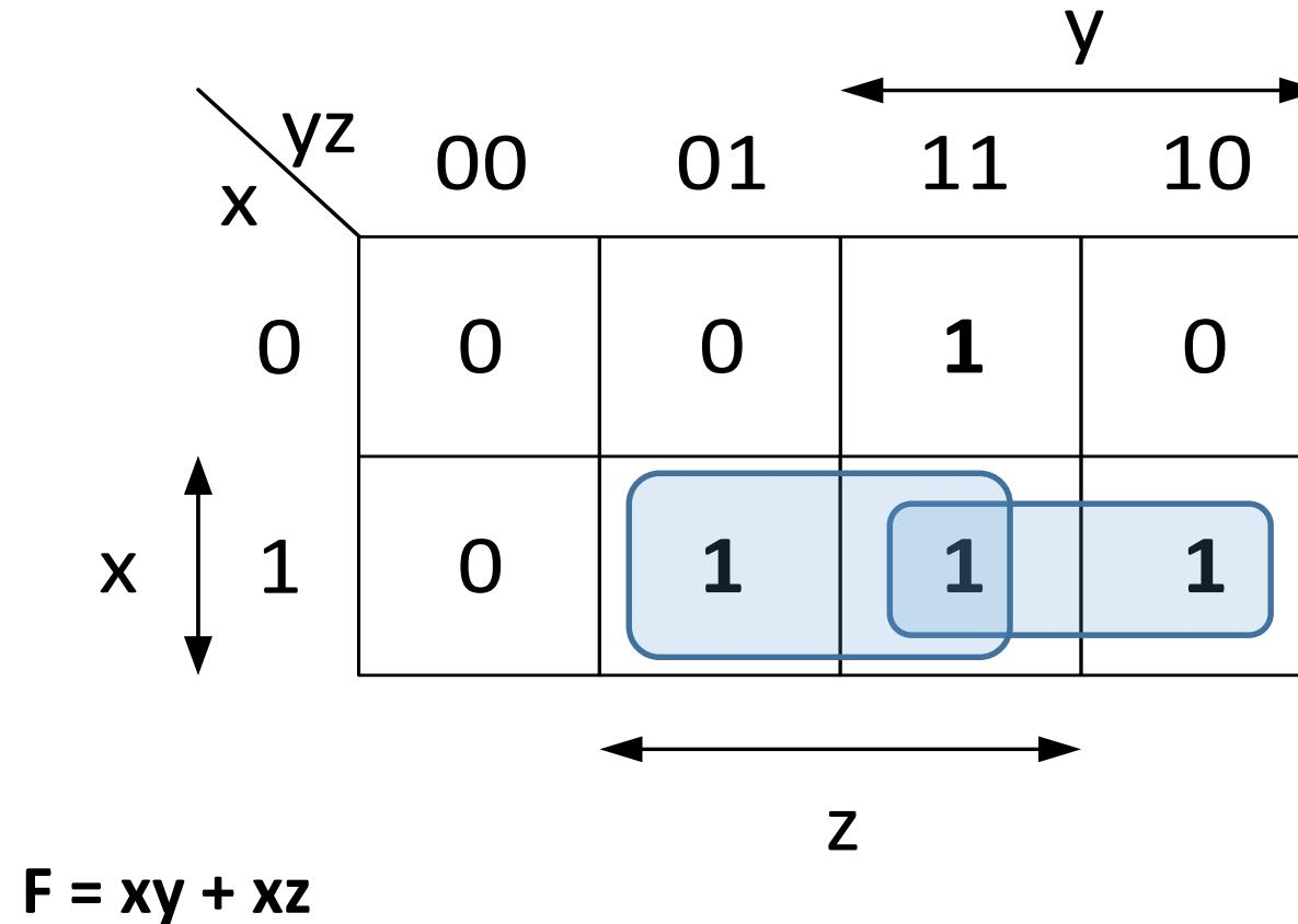
**Παράδειγμα 4.2:** Να απλοποιηθεί με πίνακα Karnaugh η συνάρτηση πλειοψηφίας τριών εισόδων που εξετάσαμε στο Παράδειγμα 3.7.
