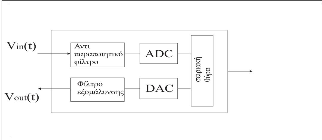
Το ΑΙC χρησιμοποιείται για να χειρίζεται όλες τις μετατροπές από αναλογικό σε ψηφιακό. Αυτό επικοινωνεί με τον 'C31 δια μέσου της σύγχρονης σειριακής θύρας. Έχει ένα D/A και ένα A/D με ανάλυση 14 bit. Έχει επίσης ενσωματωμένα ένα αντιπαραπομπικό φίλτρο και ένα φίλτρο εξομάλυνσης. Δύο συνδετήρες RCA παρέχουν αναλογική είσοδο και έξοδο στην πλακέτα. Επίσης είναι δυνατό να αποσυνδέσουμε ολοκληρωτικά το ΑΙC και να χρησιμοποιήσουμε μια πλακέτα επέκτασης.
