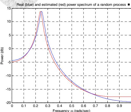
■ Στο διπλανό σχήμα φαίνεται το φάσμα ισχύος της στοχαστικής διεργασίας εισόδου (μπλε χρώμα) και η εκτίμηση του με τη βοήθεια του αλγορίθμου LMS (κόκκινο χρώμα)
