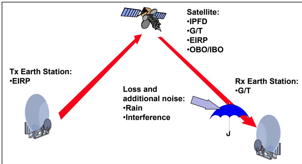
**Fig. 1.22 Link budget parameters.**
